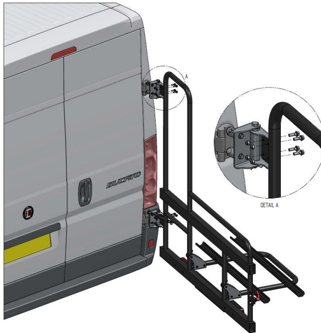
Afb. 4.5 montage frame aan scharnieren
